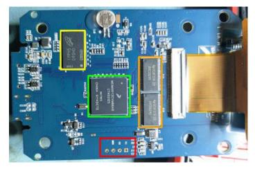
► Yellow D9SHD Micron 4Gb DDR3-1866 Orange AVC16245 TI bus transceiver ► Green MCIMX6Y2CVM08AB NXP i.MX6ULL Red ► GND / RX / TX ► UART ?
